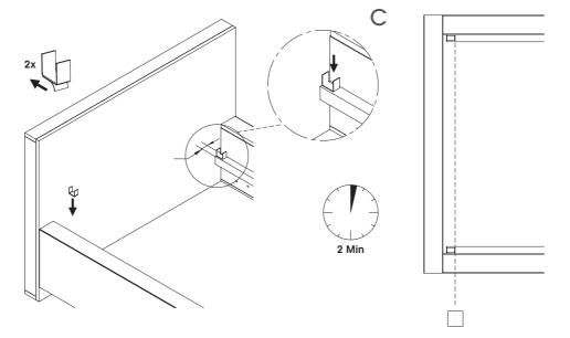
• Setzen Sie dann den obersten Querholm auf beiden Seiten in die Metallclips ein (Abb. D) ein und rollen Sie den Lattenrost langsam aus.
