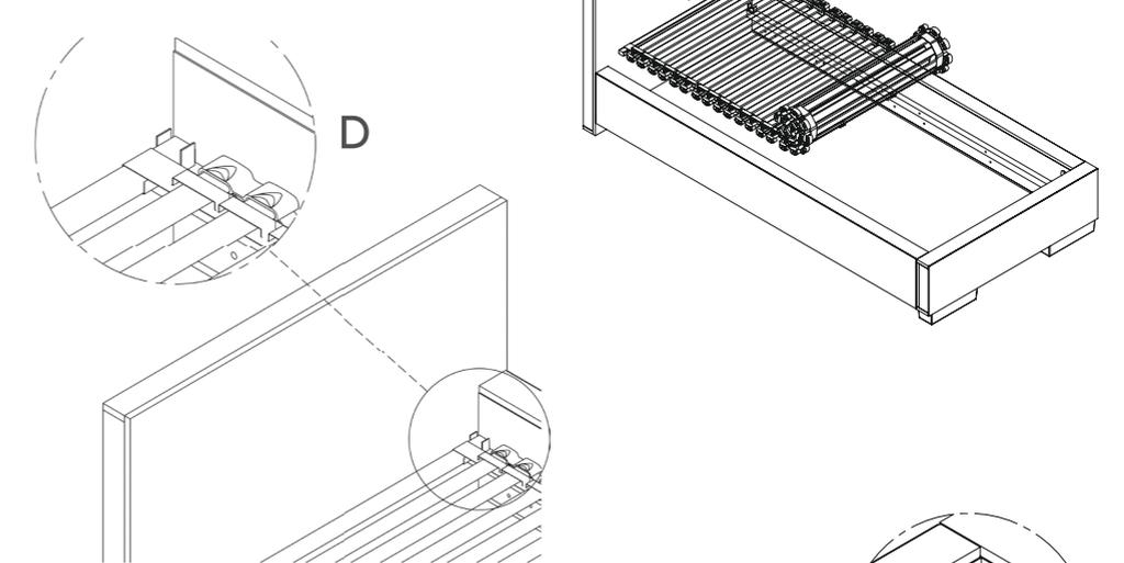
Fixieren Sie nun die beiden anderen Metallclips am unteren Ende des Bettes. Bitte prüfen Sie vorab die finale Position des letzten Querholms (Siehe Abb. E). Gehen Sie dabei analog der Beschreibung bei Schritt C vor. Warten Sie 2 Minuten, bevor Sie den letzten Querholm in die Metallclips setzen.
