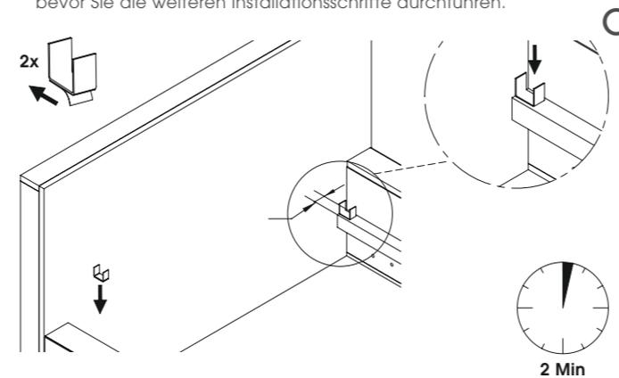
Setzen Sie den ersten Querholm in die Metallclips ein und rollen Sie den Lattenrost langsam aus.
